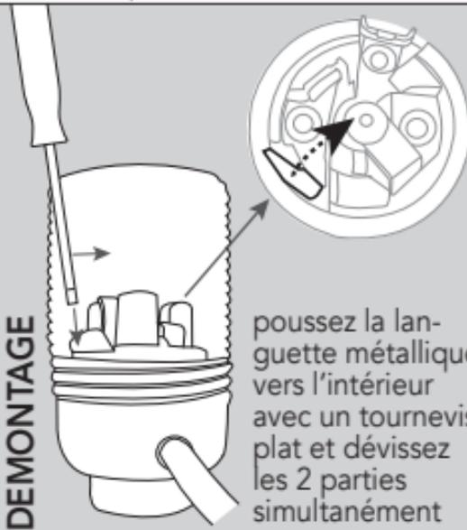
poussez la languette métallique vers l'intérieur avec un tournevis plat et dévissez les 2 parties simultanément
