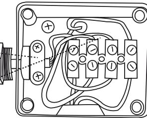
4/ serrez fermement les 2 vis du serre-câble et l'écrou du presse-étoupe
