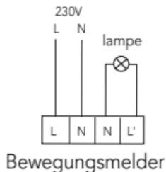
Bei diesem Anschluss wird die Leuchte durch den Bewegungsmelder gesteuert. Bei jeder Bewegung in dem vom Bewegungsmelder erfassten Bereich wird die Leuchte eingeschaltet.
