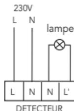
Avec ce branchement, le luminaire est commandé par le détecteur. A chaque passage dans la zone couverte par le détecteur, le luminaire se déclenche.
