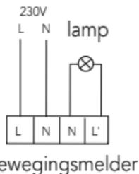
Met deze aansluiting wordt de lamp bestuurd door de melder. Bij elke doorgang in de zone die door de melder wordt gedekt, wordt de lamp geactiveerd.
