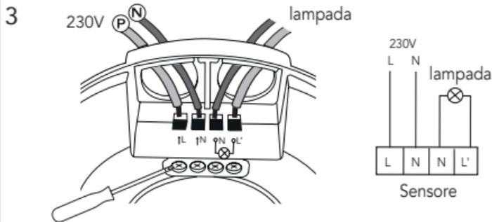
Una volta collegato, il lampadario è azionato dal rilevatore. Ogni volta che si passa nella zona di rilevamento, la luce si accende.
