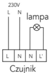
Dzięki temu podłączeniu oprawa jest sterowana przez czujnik. Za każdym razem, gdy nastąpi przejście przez obszar nadzorowany przez czujnik włącza się światło.
