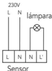
Con esta conexión, la lámpara está controlada por el sensor. A cada paso en la zona cubierta por el sensor, la lámpara se enciende.
