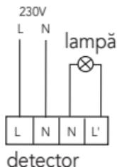
Cu această conexiune, corpul de iluminat este controlat de către senzor. Corpul de iluminat se declanșează de fiecare dată la trecerea prin zona acoperită de detector.
