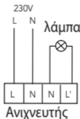
Με αυτήν τη σύνδεση, ο χειρισμός του φωτιστικού πραγματοποιείται μέσω του ανιχνευτή. Με κάθε διέλευση από τη ζώνη που καλύπτεται από τον ανιχνευτή, ενεργοποιείται το φωτιστικό.
