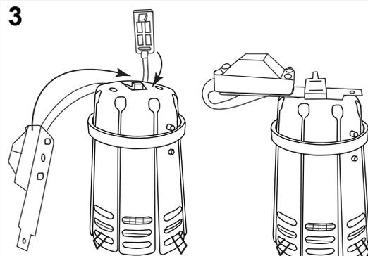
Bloquez le boîtier de connexion en fermant le clip situé au dessus du TIBISOL
