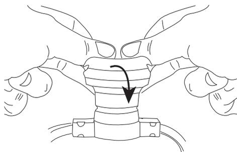
**2** FR/ Serrer les ampoules correctement GB/ Tighten bulbs properly ES/ Apriete las bombillas correctamente IT/ Stringere le lampadine correttamente PT/ Apertar as lâmpadas corretamente DE/ Glühbirnen richtig anziehen NL/ Draai de lampen goed vast PL/ Prawidłowo dokręć żarówkę RO/ Strângeți becurile în mod corect GR/ Σφίξτε τους λαμπτήρες σωστά
