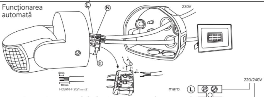
Cu această conexiune, corpul de iluminat este controlat de către senzor. Corpul de iluminat se declanșează de fiecare dată la trecerea prin zona acoperită de detector.
