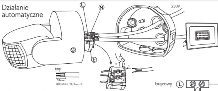
Dzięki temu podłączeniu oprawa jest sterowana przez czujnik. Za każdym razem, gdy nastąpi przejście przez obszar nadzorowany przez czujnik włącza się światło.
