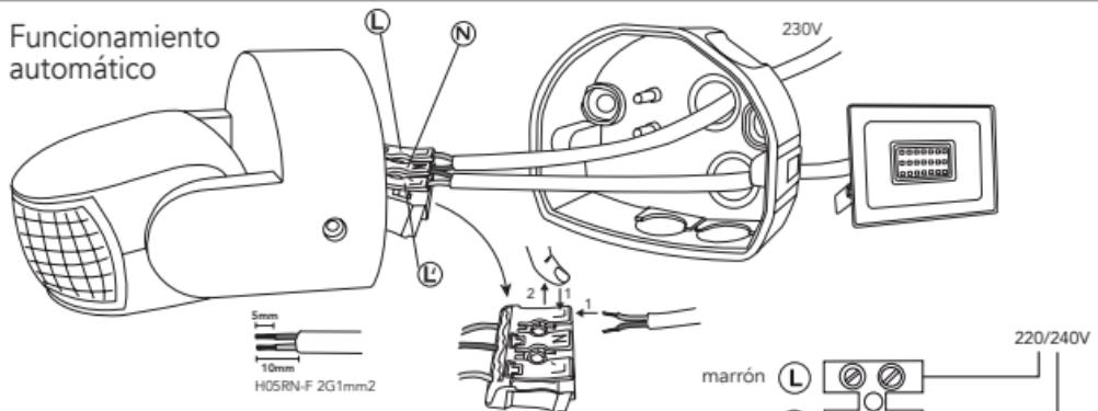
Con esta conexión, la lámpara está controlada por el sensor. A cada paso en la zona cubierta por el sensor, la lámpara se enciende.
