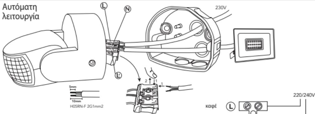
Με αυτήν τη σύνδεση, ο χειρισμός του φωτιστικού πραγματοποιείται μέσω του ανιχνευτή. Με κάθε διέλευση από τη ζώνη που καλύπτεται από τον ανιχνευτή, ενεργοποιείται το φωτιστικό.
