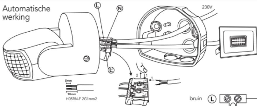
Met deze aansluiting wordt de lamp bestuurd door de melder. Bij elke doorgang in de zone die door de melder wordt gedekt, wordt de lamp geactiveerd.
