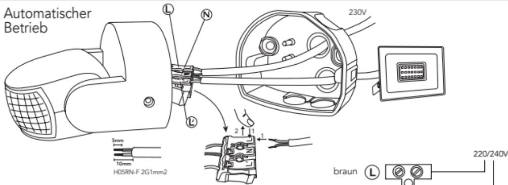
Bei diesem Anschluss wird die Leuchte durch den Bewegungsmelder gesteuert. Bei jeder Bewegung in dem vom Bewegungsmelder erfassten Bereich wird die Leuchte eingeschaltet.
