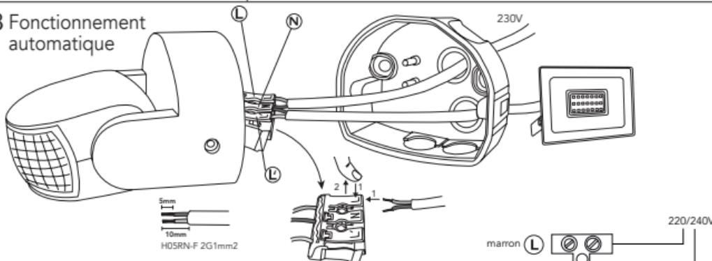
Avec ce branchement, le luminaire est commandé par le détecteur. A chaque passage dans la zone couverte par le détecteur, le luminaire se déclenche.
