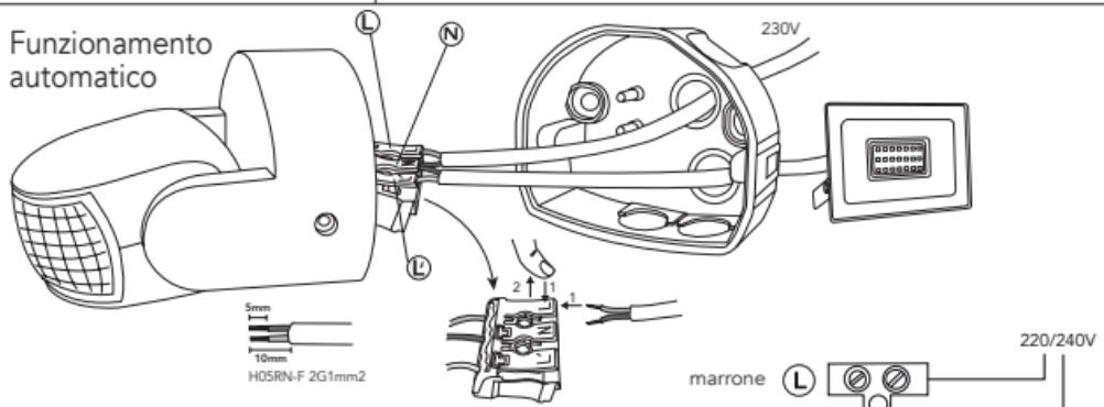
Una volta collegato, il lampadario è azionato dal rilevatore. Ogni volta che si passa nella zona di rilevamento, la luce si accende.
