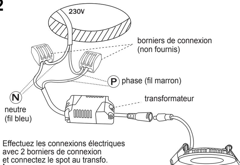
Effectuez les connexions électriques avec 2 borniers de connexion et connectez le spot au transfo.
